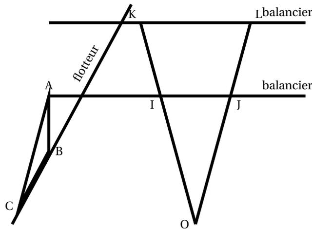
1. Pour vérifier que les deux bras du balancier sont parallèles entre eux, il place sur ceux-ci deux bois rectilignes schématisés sur le dessin ci-dessus par les segments  $[OK]$  et  $[OL]$  avec  $I \in [OK]$  et  $J \in [OL]$ .
